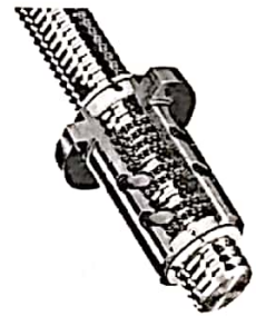
Figure 6 : Vue écorchée d'une vis à bille
